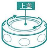
2. 如图所示，按照箭头方向（顺时针旋转）将上盖转紧。
