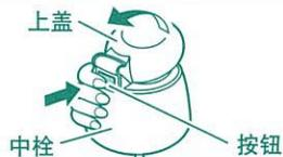
**2 轻轻按住吸管头、同时按箭头方向转动吸管固定圈取下**
