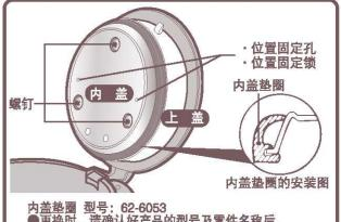
內盖型圈型号: 62-6053 ●更换时,请确认好产品的型号及零件名称后, 去经销店购买更换。
