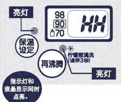
发生以下的情况时，为了防止过热而导致故障，防止空烧功能启动，以停止加热器的供电，同时以液晶显示信息和亮灯告知。
