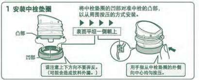
●请正确安装上盖组、上盖垫圈、中栓、杯盖垫圈、中栓垫圈。 (以免操作不良导致饮料外漏。
