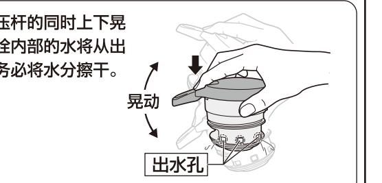
如图所示在按下压杆的同时上下晃动几次，进入中栓内部的水将从出水孔中流出，请务必水分擦干。
