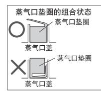
2. 将蒸气口盒的轴部(2处)插入蒸 气口盖的插孔(2处),直到手指 按压部发出"咔嚓"声为止
