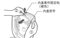
●在没有按压内盖套件固定钩时,请不 要强行拉扯内盖把手和内盖垫圈。 会造成内盖套件或外盖故障。
