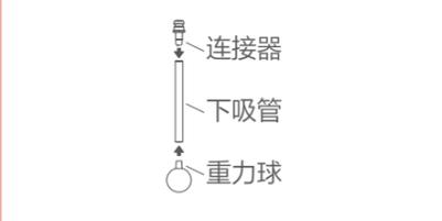
**1. 下吸管组件安装:** 将连接器、重力球分别与下吸管两头连接，请注意将吸管塞到底。
