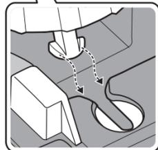
③ 将紧固件下移至接头密封橡胶的下方。
