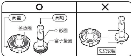
② 将阀轴和阀弹簧安装到阀上，然后沿箭头方向旋转并关好阀盖。
