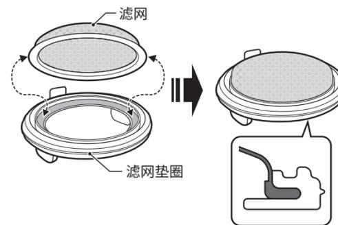
② 将滤网垫圈组安装到抽出中栓上，然后安装中栓上盖。
