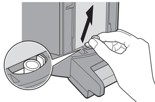
②从下连接管上取下水位管盖（下）。
