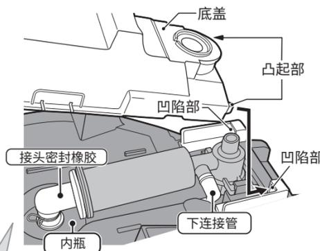
② 将底盖的卡爪(2处)对齐主机孔部(2处)进行安装。
